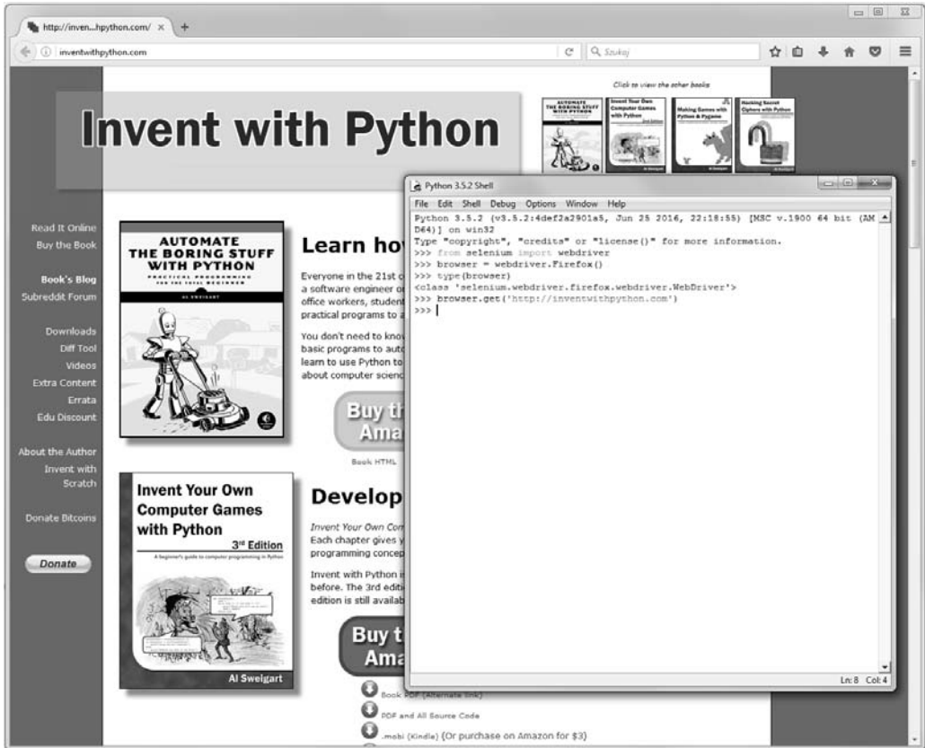
Rysunek 11.7. Po wywołaniach webdriver.Firefox() i get() w środowisku IDLE na ekranie pojawia się okno wskazanej przeglądarki WWW (tutaj to Firefox)
